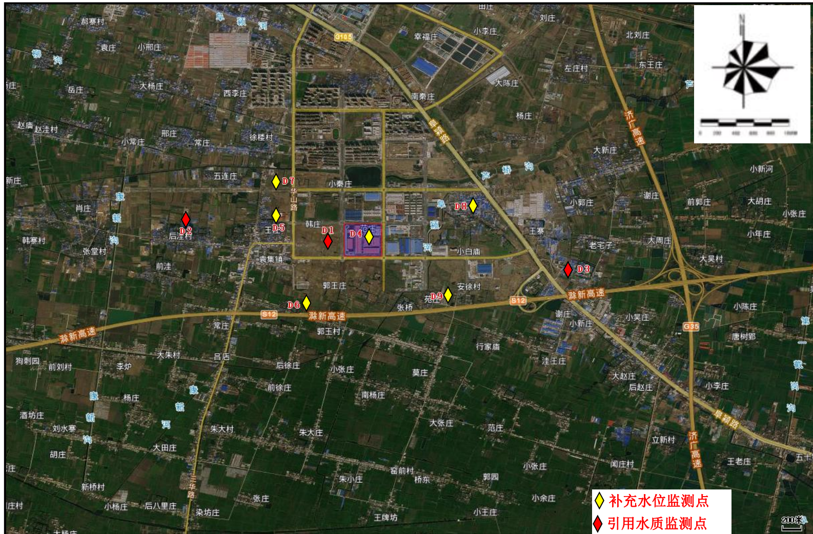
图4.2-2 地下水现状监测布点图
